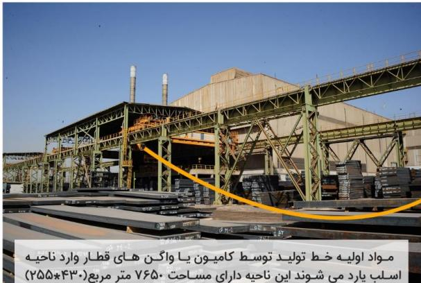
مواد اولیه خط تولید توسط کامیون یا واگن های قطار وارد ناحیه اسلب یارد می شوند این ناحیه دارای مساحت ۷۶۵۰ متر مربع (۲۵۵\*۴۳) بوده و با ۳ جرثقیل سقفی مگنتی تجهیز شده است که بر حسب نیاز می توان هر کدام را بصورت چنگکی (جهت انتقال اسلب های گرم برگشتی از کوره) تعویض نمود، ظرفیت هر کدام از جرثقیل ها به بارت دیگر ۸۰ تن می باشد.
